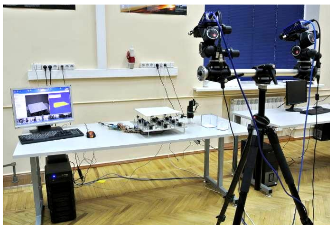
Внешний вид комплекса измерения деформации поверхности методом корреляции фоновых изображений
